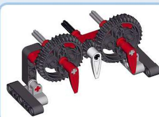
Рис. 11.9. Зубчатая передача с колесами 36T (слева), 12T (в центре) и второго 36T (справа)
