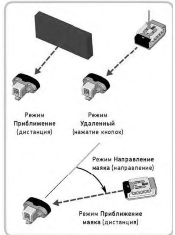
Рис. 8.1. Режимы работы инфракрасного датчика. Красные пунктирные линии обозначают невидимые лучи инфракрасного света. Если вы преградите путь между датчиком и маяком, датчик не сможет взять правильные замеры
