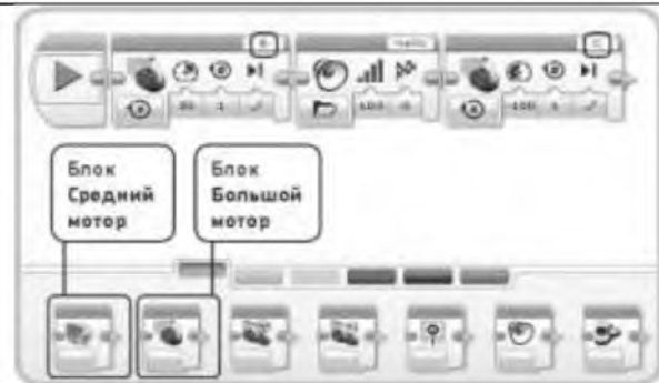
Рис. 4.20. Программа LargeMotor: Левый мотор вращается вперед, робот говорит «Пивет!», правый мотор вращается в обратном направлении
